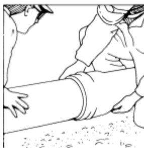
Slika 3. Izvesti spajanje cijevi ili spojnice laganim i naizmjenično uzdužnim zakretanjem druge cijevi ili spojnice. Preporuča se da se ugurani ravni dio cijevi vrati unatrag za 10-15 mm zbog istezanja ili stezanja PVC cijevi uslijed temperaturnih promjena. Pregibanje na spoju u naglavku (kolčaku) nije dozvoljeno.
