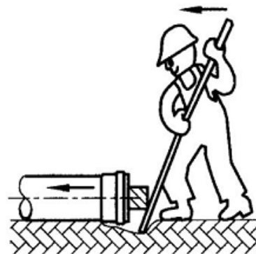
Slika 4. Kod većih promjera cijevi samo spajanje izvesti s polugom, pri čijem korištenju treba spriječiti eventualno oštećenje cijevi korištenjem klade (kloce) između cijevi i poluge
